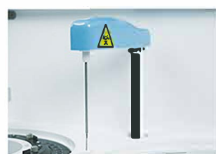
Sonda de muestra y reactivo Función de sensor de nivel de líquido. Función anti colisión. Detección en tiempo real del volumen de reactivo.
