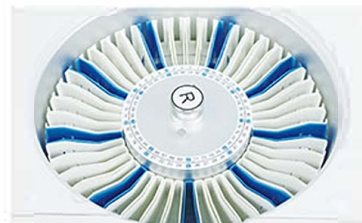
Bandeja de reactivos refrigerada 2~8°C por 24 horas.
