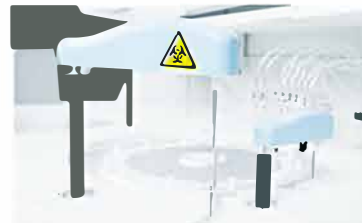
Sonda de muestra Función de sensor de nivel de liquido. Función anti colisión. Detección en tiempo real del volumen de muestra.
